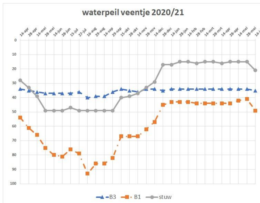
Figuur 1 Tabel met waterstanden t.o.v. bovenkant peilbuis van twee peilbuizen en de stuw (Bron: Hans van Rijn)
